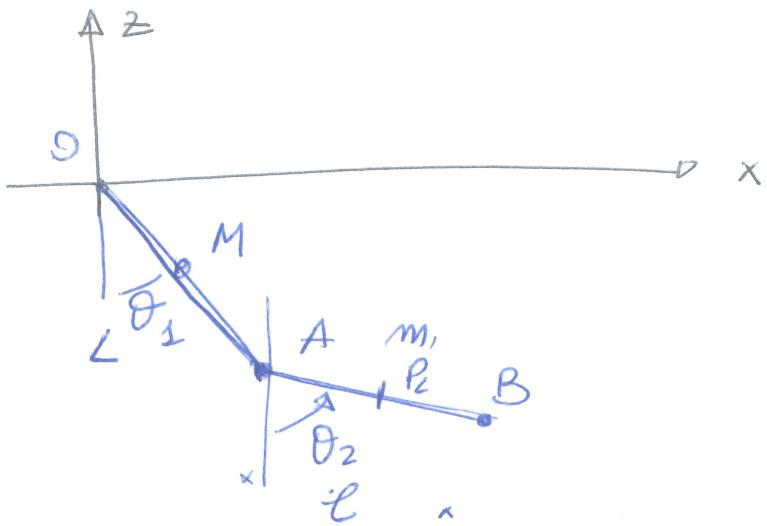
$$T_{OA} = \frac{1}{2} I_o^{yy} \omega^2 \quad (\text{risulta attorno il pt. fimo})$$
