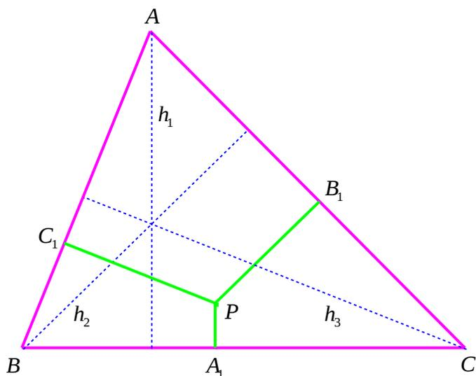
Il teorema di Viviani può essere generalizzato al caso di triangoli qualunque<sup>(10)</sup>. Preso un punto  $P$  interno o sui lati di un triangolo  $ABC$ , indicate con  $PA_1$ ,  $PB_1$  e  $PC_1$  le distanze di  $P$  dai lati (o dai loro prolungamenti) del triangolo e con  $h_1$ ,  $h_2$  e  $h_3$  le altezze del triangolo rispettivamente parallele a  $PA_1$ ,  $PB_1$  e  $PC_1$ , sussiste l'uguaglianza
