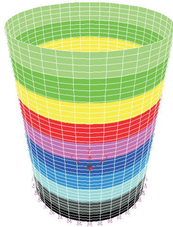
Figura 23: Output di SAP2000 delle sollecitazioni di parallelo N^{\theta\theta} di un cilindro caricato con peso proprio e pressione idrostatica.
